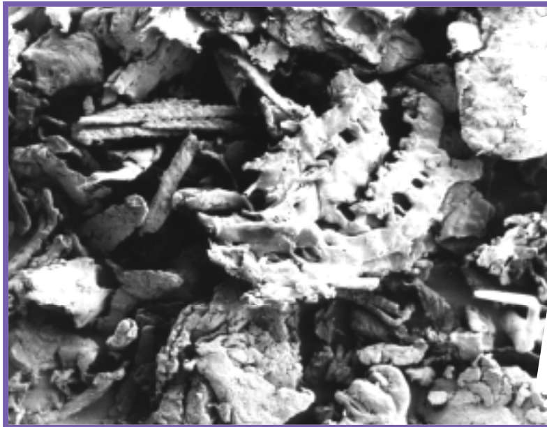
Bild 7.1: Partikelmorphologie von Maiskolbenmehl: Zerklüftete, abgerundete Partikel mit Größen zwischen 50–150µm. Teilweise repetitive Struktureinheiten bzw. vollständig glatte Fäden erkennbar.
